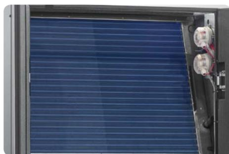
Alle Modelle der Baureihe **JREF C DX** sind serienmäßig mit Wärmetauscherregistern mit **hydrophiler Behandlung** ausgestattet. Die spezielle Verkleidung und eine angemessene Wahl der Durchquerungsgeschwindigkeit des Luftstromes begünstigen das Aufnehmen des Kondenswassers im Entfeuchtungsprozess, wodurch das Nachziehen von Tropfen inner- und außerhalb des Geräts vermieden wird.
